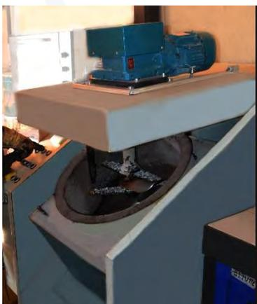
Le miscele sono state confezionate in laboratorio per mezzo di un miscelatore termostato per conglomerati bituminosi (Infratest), impiegando una percentuale di legante del 5% in peso riferita agli inerti. Sono stati realizzati conglomerati bituminosi dosando gli additivi in percentuali variabili tra lo 0,4 e lo 0,6% sul peso del legante.
