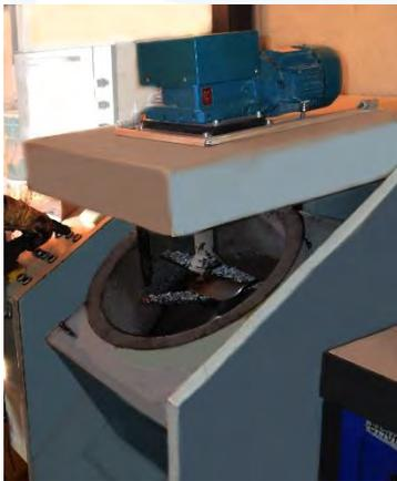
Le miscele sono state confezionate in laboratorio per mezzo di un miscelatore termostato per conglomerati bituminosi (Infratest), impiegando una percentuale complessiva di legante del 5% in peso riferita agli inerti (bitume vecchio+nuovo). Sono stati realizzati conglomerati bituminosi al 40 e 50% di fresato, dosando l'additivo ACF WARM-MIX 40 rispettivamente allo 0,37% e allo 0,41% sul peso del fresato.
