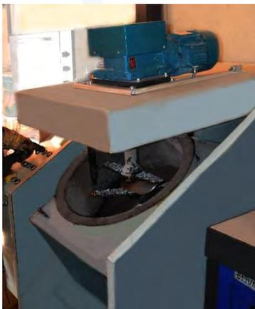
Le miscele sono state confezionate in laboratorio per mezzo di un miscelatore termostato per conglomerati bituminosi (Infratest), impiegando una percentuale complessiva di legante del 4,5% in peso riferita agli inerti (bitume vecchio+nuovo). Sono stati realizzati conglomerati bituminosi al 30% di fresato, dosando l'additivo rispettivamente allo 0,2 e allo 0,3% sul peso del fresato.
