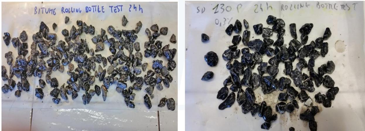
Figura 4e. Risultati Rolling Bottle Test inerti basaltici: a sinistra bitume senza additivo, a destra bitume con l'aggiunta dello 0,3% di StarDope® 130 P.
