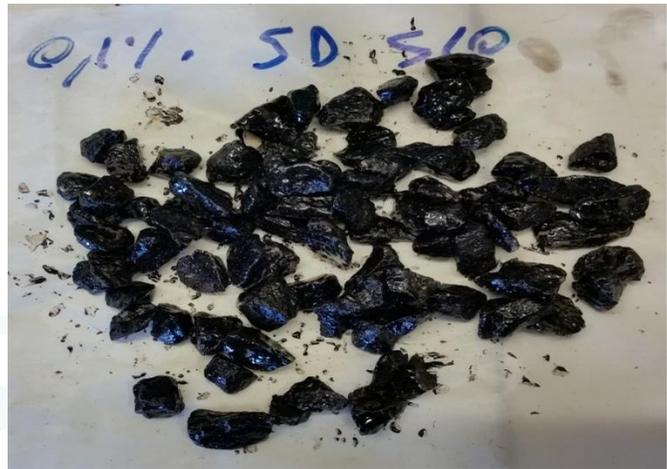
Figura 6a. Risultati Boiling Water Stripping Test inerti basaltici: a sinistra bitume senza additivo, a destra bitume con l'aggiunta dello 0,1% di StarDope® 510.
