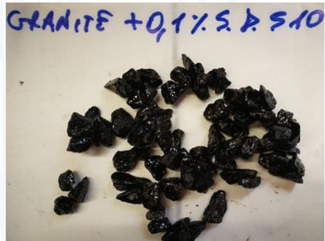
Figura 6b. Risultati Boiling Water Stripping Test inerti granitici: a sinistra bitume senza additivo, a destra bitume con l'aggiunta dello 0,1% di StarDope® 510.
