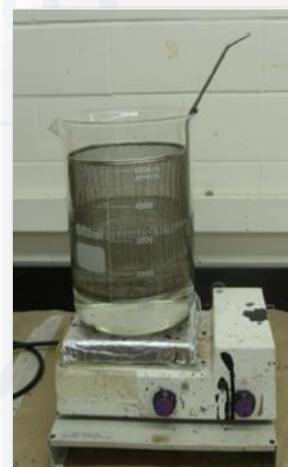
La seconda tecnica prevede il posizionamento dei campioni di prova all'interno di contenitori di vetro pieni d'acqua a temperatura ambiente. Tali contenitori vengono fatti ruotare ed agitare per un periodo di tempo variabile (fino a 24 ore) ed ispezionati ogni 6 ore dando una valutazione visiva del grado di copertura del bitume, in percentuale sugli inerti.
