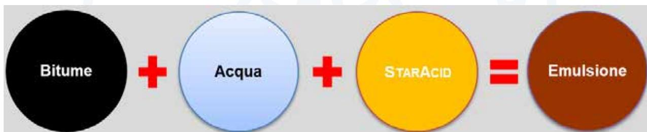
Gli additivi denominati StarAcid e StarBas, a seconda della tipologia di emulsione bituminosa che si desidera produrre, se cationica o anionica rispettivamente, sono appositamente utilizzati in formulazioni complesse studiate nei laboratori Star Asphalt per la produzione di conglomerati perfettamente plastici e lavorabili a freddo.
