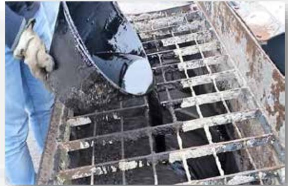
Ricicla è un legante bituminoso per il riutilizzo del fresato stradale a temperatura ambiente. La sua particolare composizione permette di svolgere nei confronti del bitume vecchio, presente nel materiale fresato, le seguenti funzioni: bagnante, rigenerante, antiossidante e plastificante. È impiegato per la produzione a “freddo” di conglomerati bituminosi plastici utilizzando il 100% di materiale fresato (RAP).
