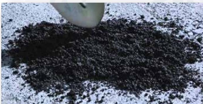
Caratteristica esclusiva dei conglomerati bituminosi ottenuti utilizzando tale panetto è l'aspetto opaco, quasi asciutto, al termine del processo produttivo, indicante un legame perfettamente stabile inerte/legante, prerequisito, questo, di durabilità della pavimentazione stradale ammalorata riparata, con un conseguente risparmio energetico, di risorse e di denaro. Inoltre, l'opacità caratterizzante tale tipologia di
