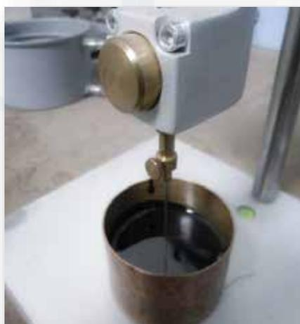
Temperatura di rammollimento SuperPatch: 47°C
